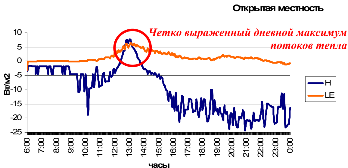
Рис 5.6. Характерный суточный ход потоков явного ( H ) и скрытого ( LE ) тепла для открытого участка местности
